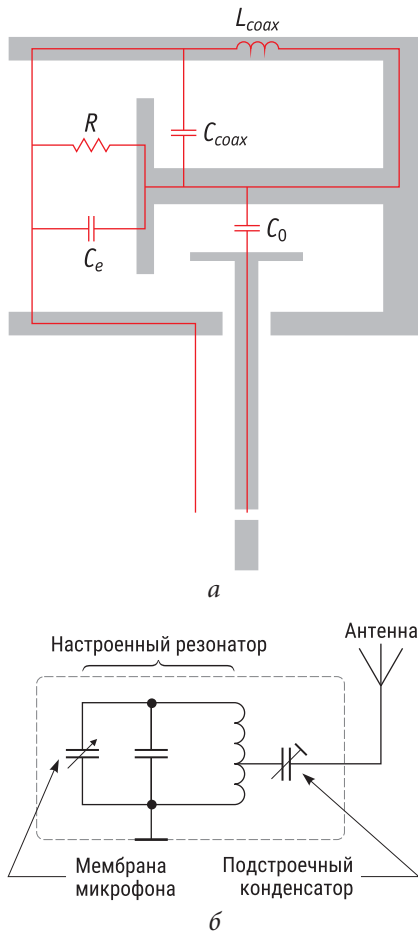
Рис. 9. Поперечное сечение преобразователя и аналогия электрической цепи (а), а также упрощенная электрическая схема (б)
