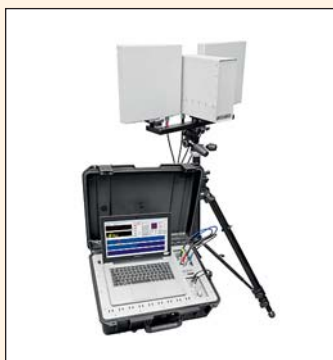
Широкополосный регистратор модуляции вторичного излучения «Ревиз-12000»
