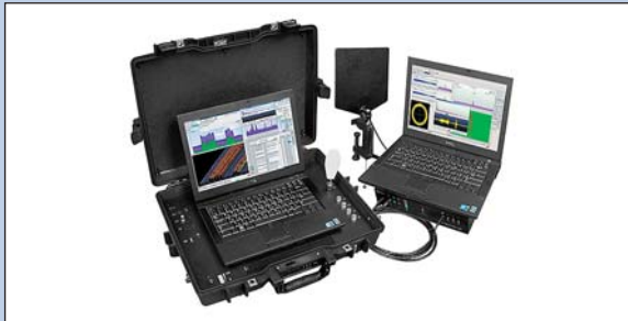
Модернизированные комплексы радиомониторинга и анализа сигналов «Кассандра-К6», «Кассандра-К21»
